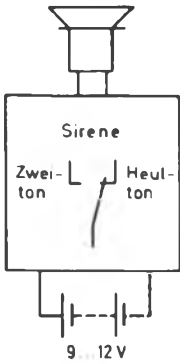
Bild 6.31: Prinzip der elektronischen Sirene, Wahlmöglichkeit zwischen Zweitton oder Heulton.
